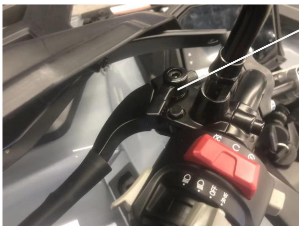
фиксатор стояночного тормоза
